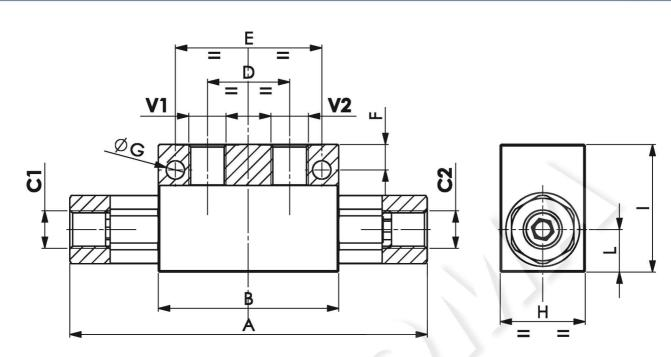
Per ottenere una perfetta tenuta della valvola si consiglia di collegare a scarico le bocche del distributore per evitare contropressioni che non permetterebbero una perfetta tenuta dell'otturatore
