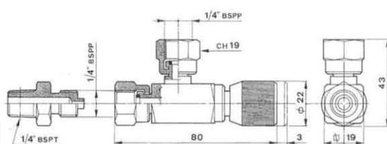
Esclusore per attacco manometro a 90°. I dadi girevoli permettono il fissaggio del manometro e dell'esclusore su di un angolo di 360°. Il connettore viene fornito in serie.
