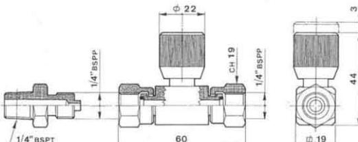
Esclusore per attacco manometro in linea. I dadi girevoli permettono il fissaggio del manometro e dell'esclusore su di un angolo di 360°. Il connettore viene fornito in serie.
