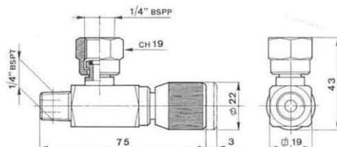
Esclusore per attacco manometro a 90°. Il dado girevole permette il fissaggio del manometro su di un angolo di 360°.
