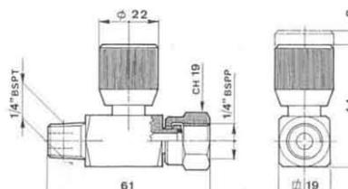
Esclusore per attacco manometro in linea. Il dado girevole permette il fissaggio del manometro su di un angolo di 360°.
